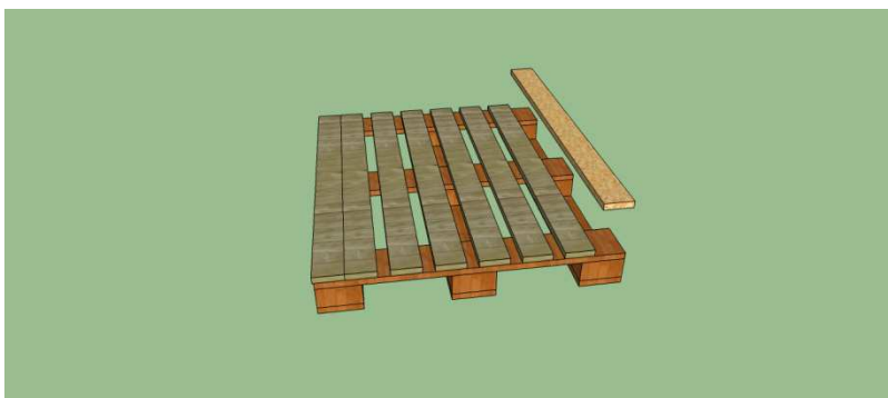
Figura 2: Ilustração remoção tirante superior do piso, Fonte: Modelo 3D criado pelos autores
